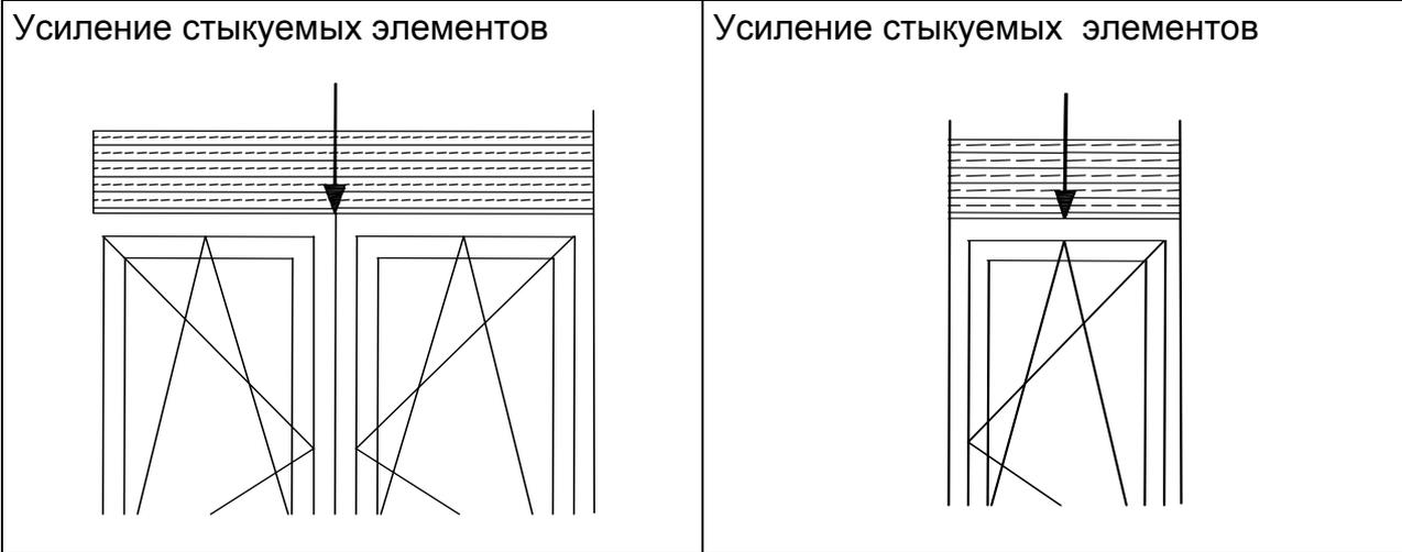
**Рис. 11** Усиление элементов.
