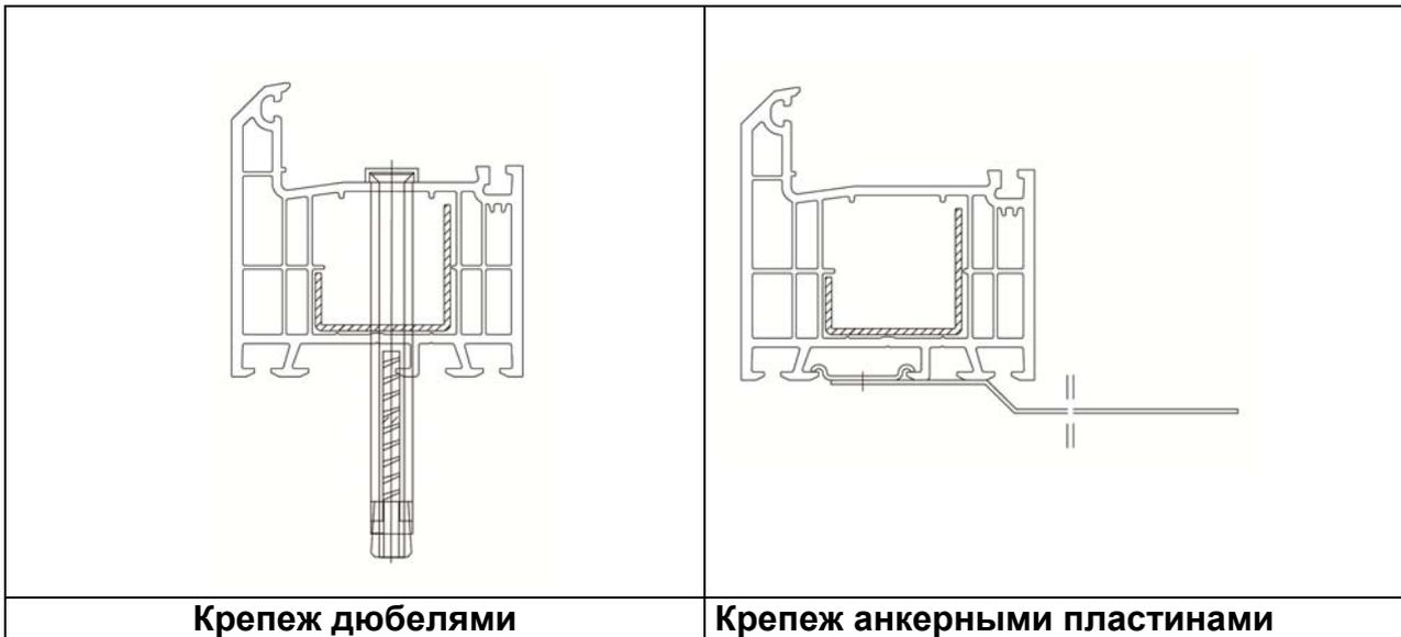
Фальц обеспечивает водоотвод. Он способствует ровному положению дюбеля.
