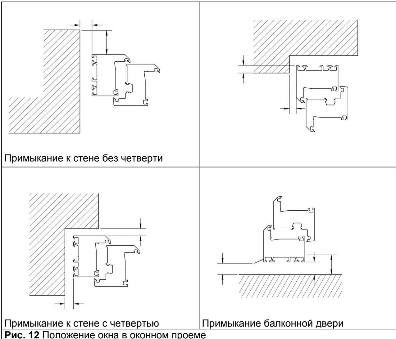
**Рис. 12** Положение окна в оконном проеме
