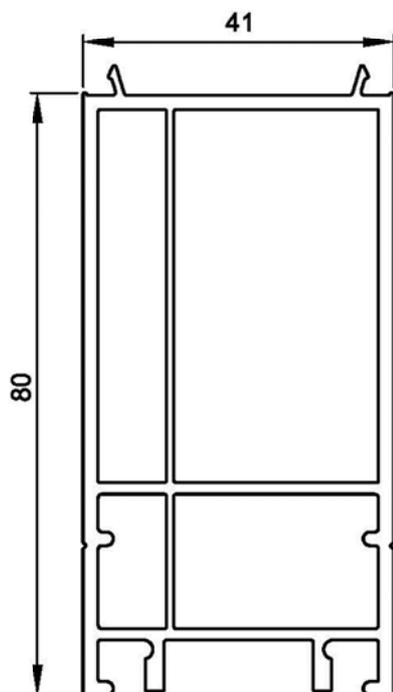
Расширитель дверного порога 35 мм
