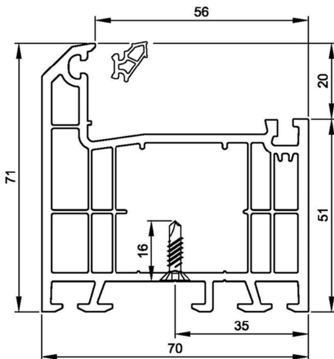
Армирование в профиле крепить саморезами напр. FD21 3.9x16мм
